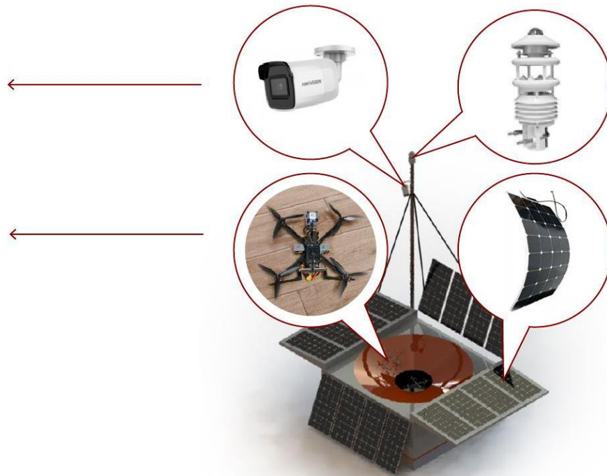
ДАК в развернутом состоянии (в режиме посадки БПЛА)
